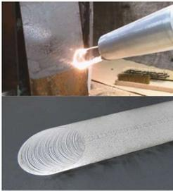
株式会社トヨコーが光産業創成大学院大学と共同開発した「CoolLaser®（クーレーザー®）」は、従来難しかった狭隘部のサビ・旧塗膜の除去ができる技術として業界から工法としての実用化が囑望されており、また光の特性を生かして軽量・無反力・クリーンという特徴から担い手の作業負荷の改善の面でも大きな期待が寄せられています。
