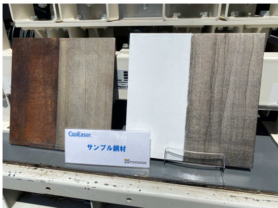
サビ・塗膜の除去前後のサンプル板
